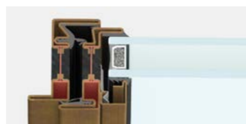
nodo laterale | sezione in vista 47 mm
