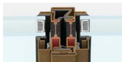
nodo centrale | sezione in vista 62 mm
