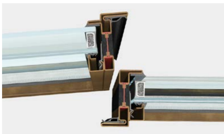
zoccolo | sezione in vista 54 mm
