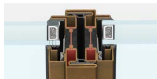
nodo centrale | sezione in vista 62 mm
