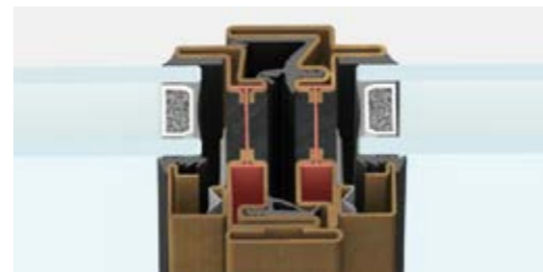
nodo centrale | sezione in vista 62 mm
