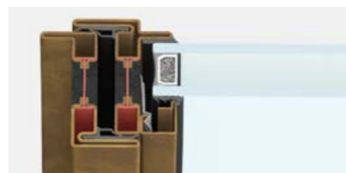
nodo laterale | sezione in vista 47 mm
